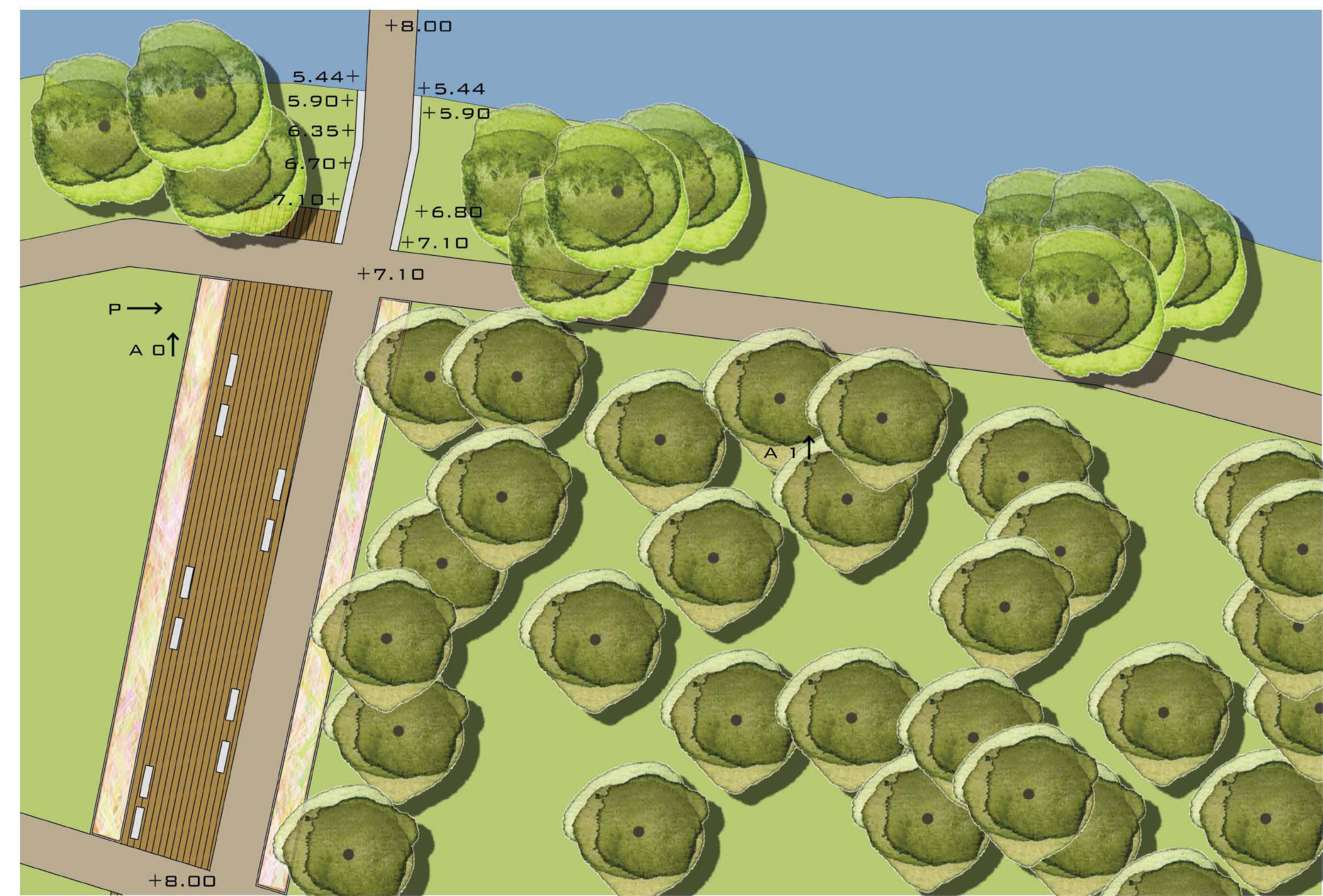
UTSNITTET VISAR HUR BROFÄSTET BYGGS UPP MED EN STÖDMUR. P=PERSPEKTIVPUNKT. A 0, A1 SNITTPUNKTER. SKALA 1:200
